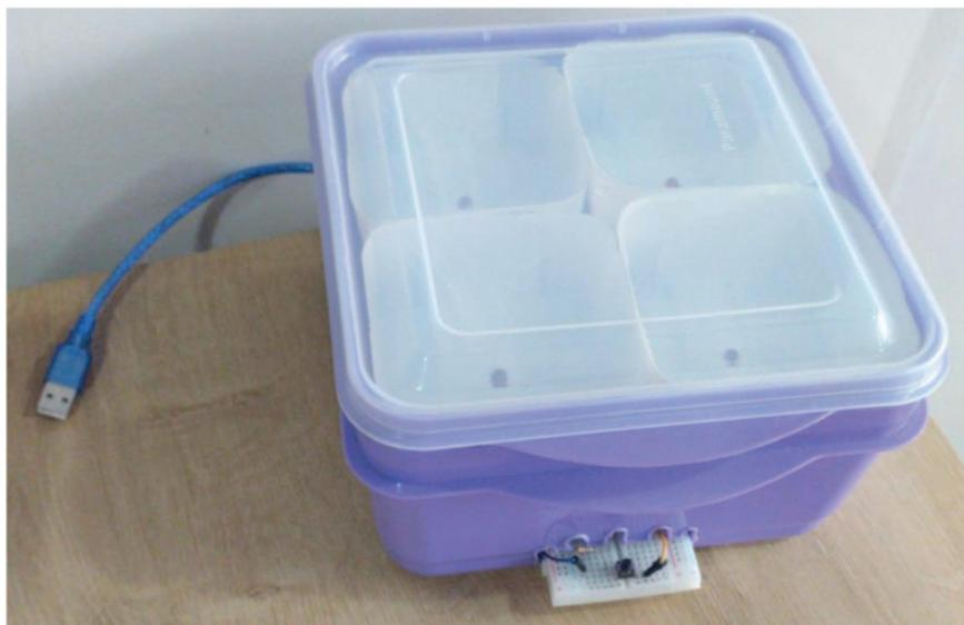
Figura 9: dispositivo final, mostrando na parte superior a quantidade de divisões, neste caso quatro, com abertura para cada LED.
