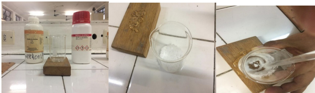
Imagem 3: Reação com reagentes sólidos: cloreto de amônio com hidróxido de bário octahidratado
