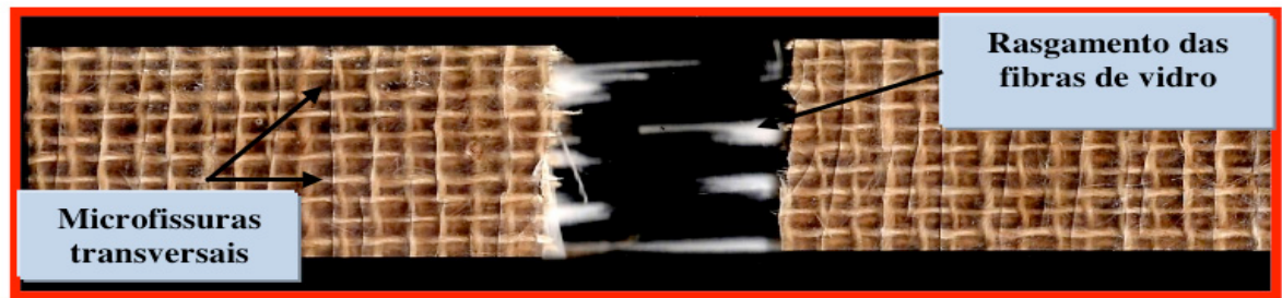
Figura 5: Característica de fratura final para os Corpos de prova WH - Detalhe da região de fratura final.
