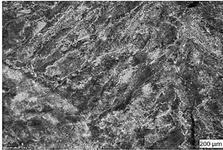
Figura 5 - Micrografia com ampliação de 5 X do cordão de solda.
