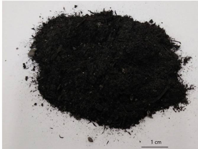
Figura 5: Imagem dos Nanotubos de Carbono fabricados no LEME.
