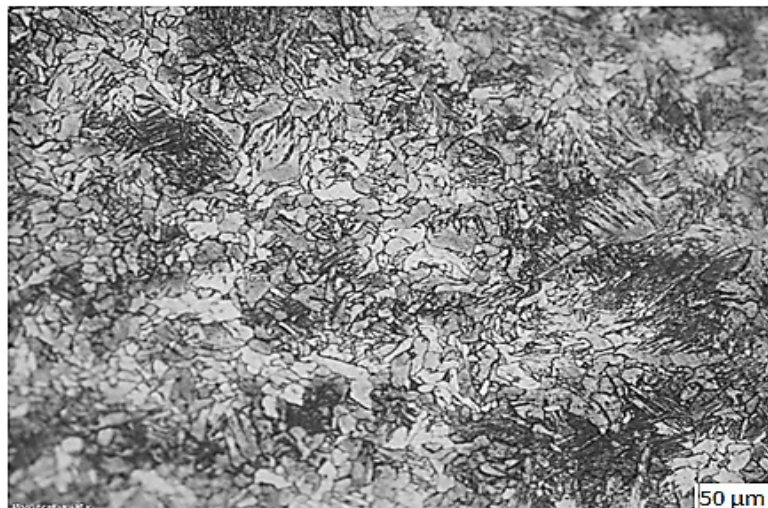
Figura 8 - Micrografia com ampliação de 20 X da Zona Termicamente Afetada.
