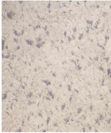
Figura 13: Microscopia da Chapa laminada a Quente, zoom 100x.
