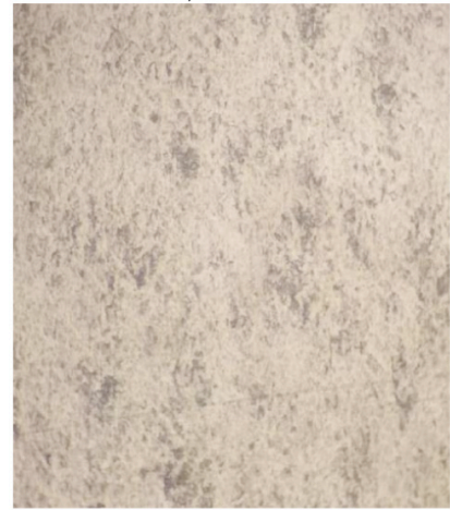
Figura 14: Microscopia da Chapa laminada a Frio, zoom 100x.
