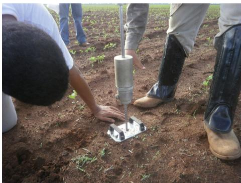
Figura 2. Penetrômetro de impacto modelo comercial IAA/PLANALSUCAR/Stolf.
