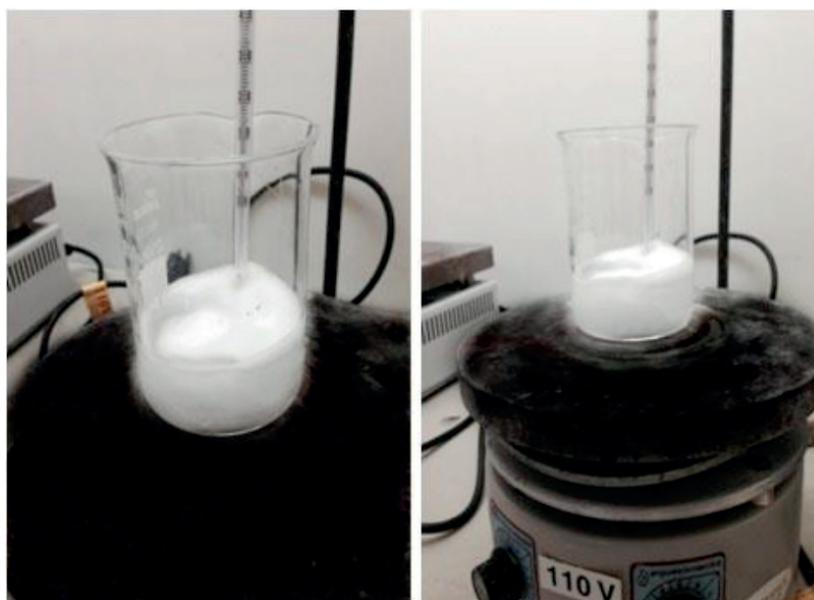
Figura 13 - Ilustração da etapa de secagem da sílica a  $35 \text{ }^\circ\text{C}$ , em capela
