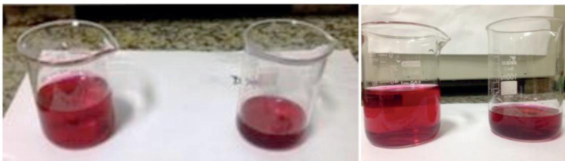
Figura 54 - Amostra ensaiada antes e depois de 60 minutos de experimento sem ajuste de pH
