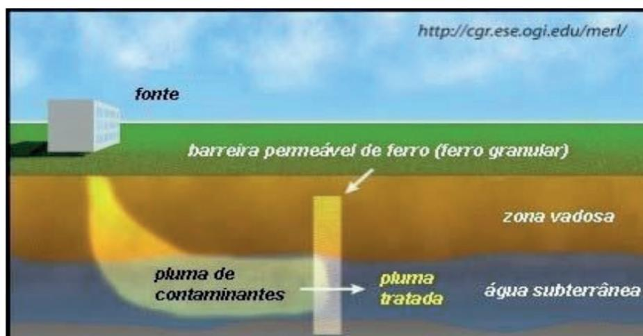
Figura 1 - Esquema de tratamento de água subterrânea utilizando-se barreira permeável reativa contendo ferro granular
