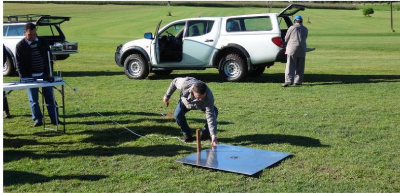
FIGURA 10 - Detalhe do aterramento da placa metálica
