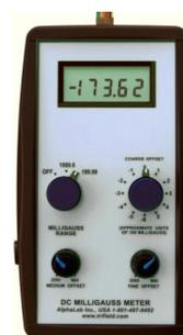
Figura 4 – Medidor de campo magnético
