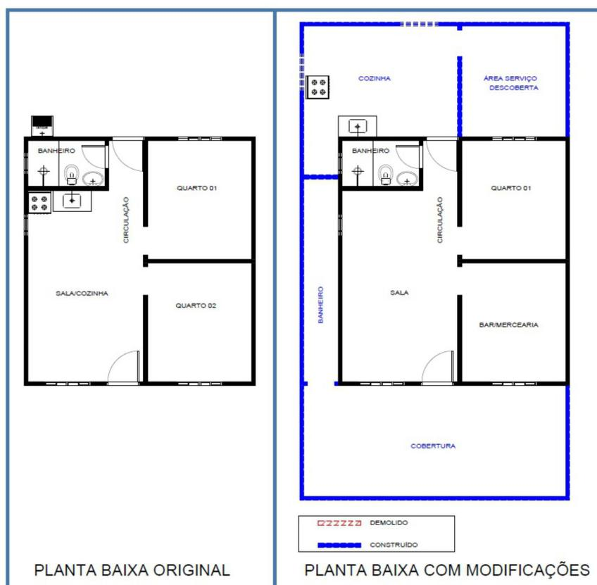
Figura 7 – Planta baixa de uma casa modificada do Projeto Taboquinha
