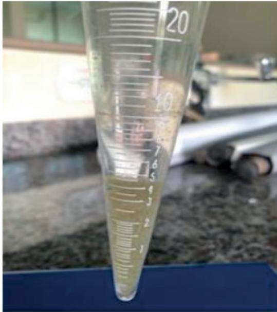
Figura 1. Amostra de água do sistema bioflocos colocado no cone imhoff, para observação da quantidade de flocos. (Fonte: Dados da pesquisa, 2019).
