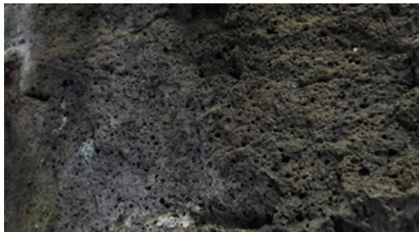
Figura 12 - Basalto amidaloidal/vesicular.
