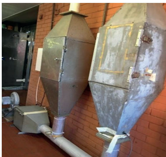
Figura 1. Secador de bandejas utilizado no estudo.
