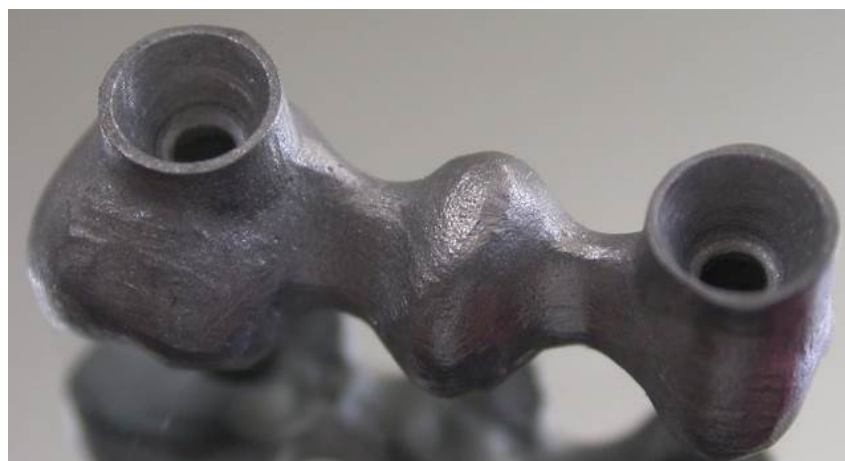
Figura 4 – Base de metal para aplicação de cerâmica.
