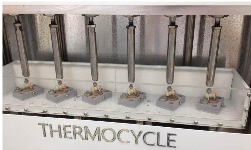
Figura 10 – Máquina para testes de fadiga por ciclagem mecânica com os corpos de teste adaptados.
