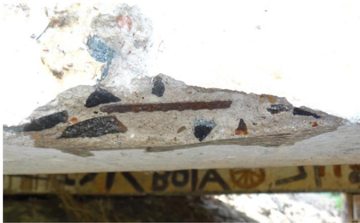
Figura 6 – Ensaio de carbonatação em longarina
