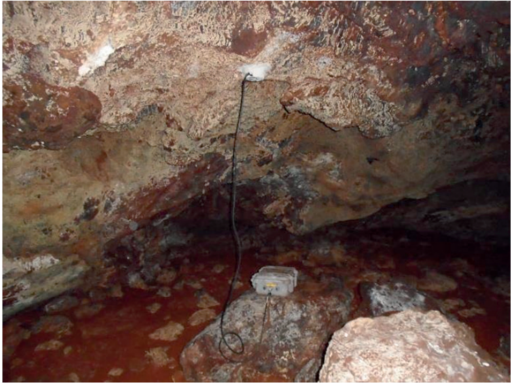
Figura 4: Geofone fixado no teto da cavidade com uso de gesso
