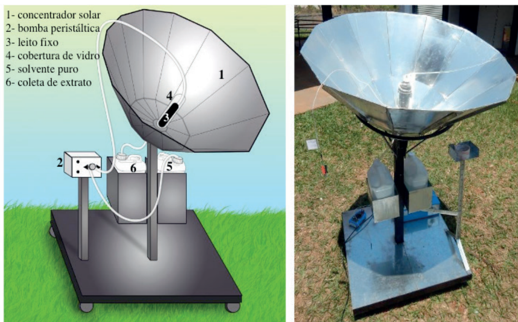
Figura 1: Unidade experimental de extração sólido-líquido: (a) esquema; (b) equipamento; (c) posicionamento concentrador solar; (d) leito fixo.
