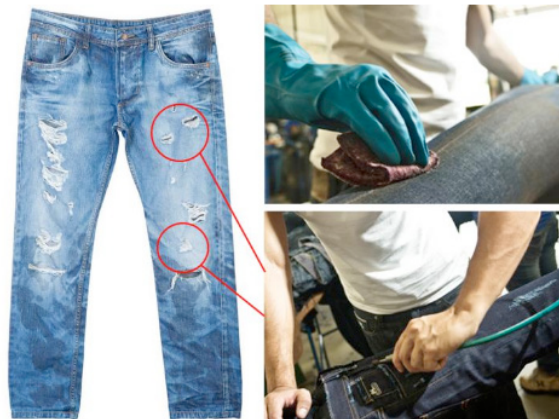
Figura 5. Acabamento manual por lixamento e por puído.
