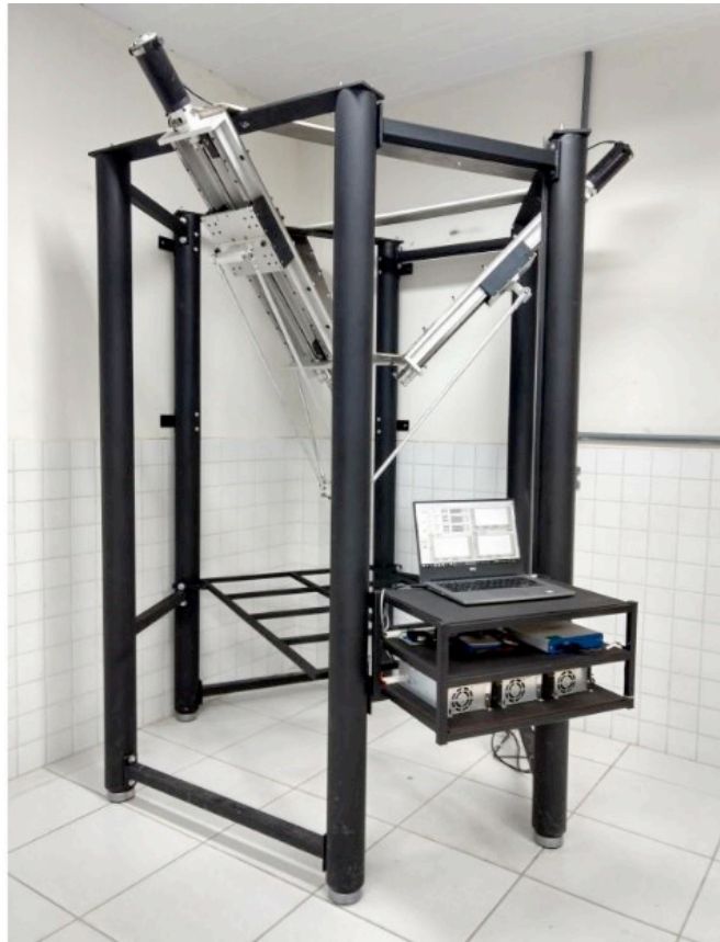
Figura 2. Mecanismo do robô paralelo proposto.
