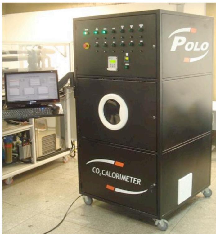
Figura 1: Calorímetro de ciclo quente para compressores de dióxido de carbono.
