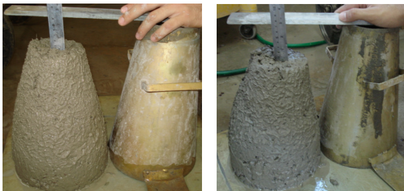
Figura 3 - Consistência pelo abatimento de tronco de cone
