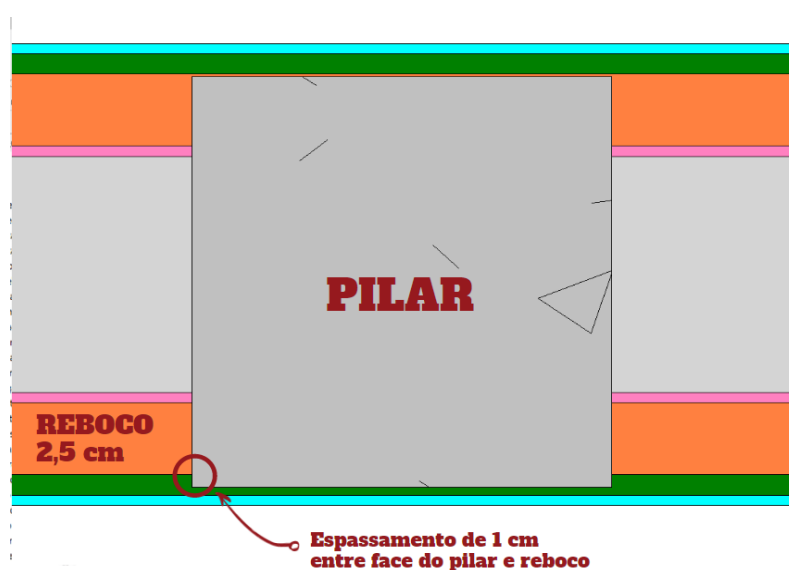
Figura 4 - Desaprumo entre pilar e reboco 2,5 cm.
