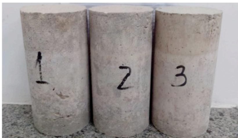
Figura 2 - Efeito da eflorescência nos corpos de prova
