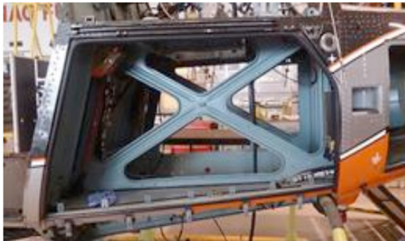
Figura 3: Estrutura compartimento do tanque.
