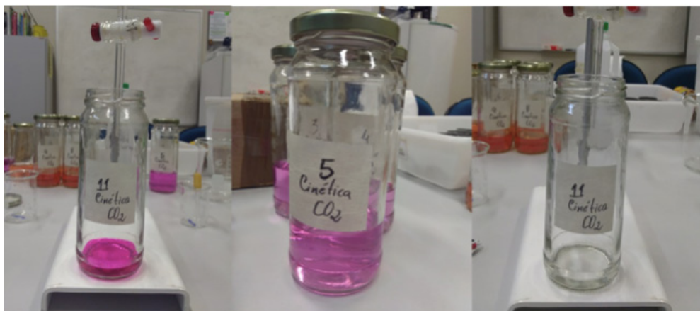
Figuras 9, 10 e 11 - Coloração das fases da solução de KOH 0,5N com o indicador fenolftaleína (1ª viragem).
