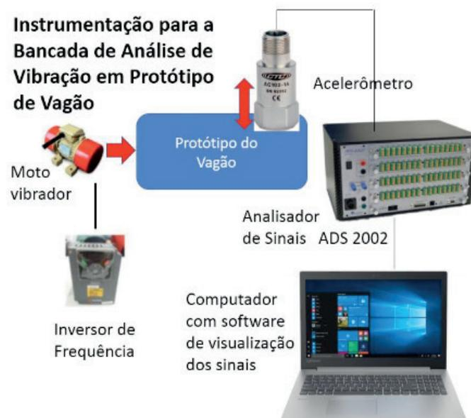
Figura 4: Esquema da instrumentação a ser utilizada na bancada.
