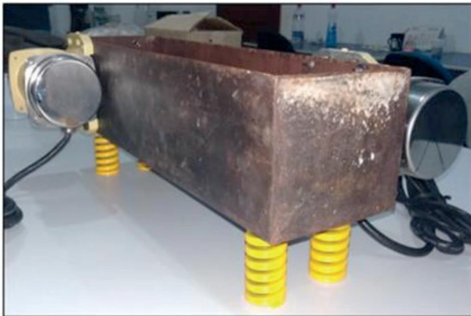
Figura 7: Protótipo de vagão a ser usado nos ensaios de vibração.
