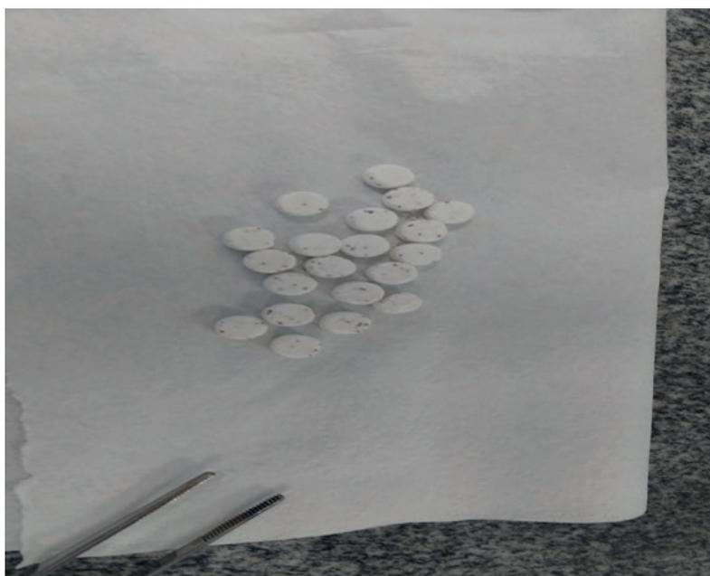
Figura 4: Comprimidos após o teste de friabilidade
