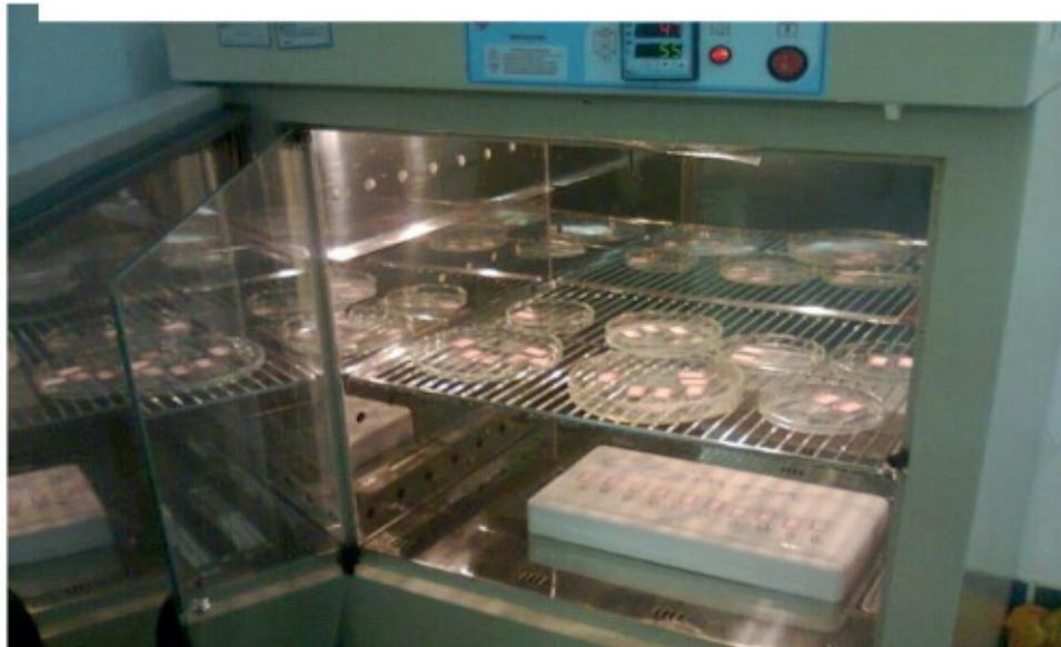
Figura 3. Lâminas em período de clarificação na estufa
