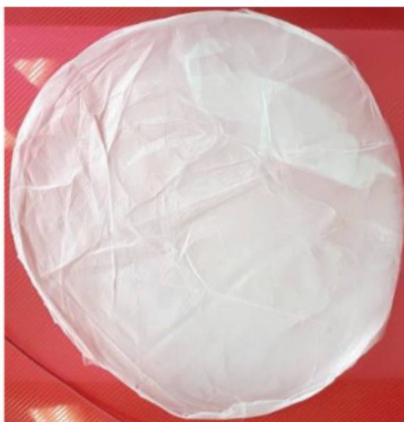
Figura 4: Filme de Ecovio® obtidos por eletrofiação.
