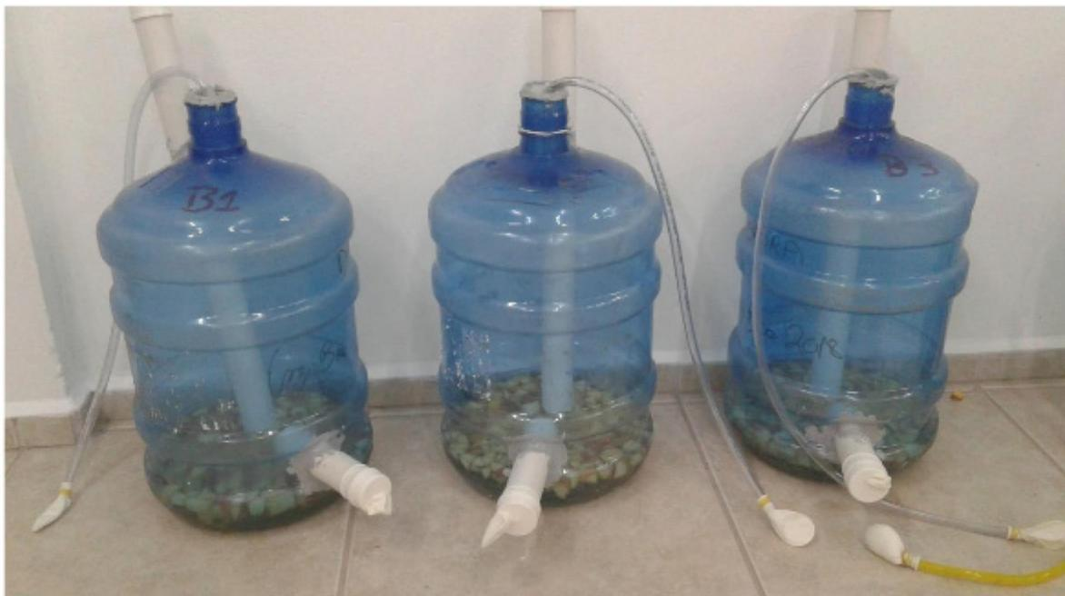
Figura 3- Biodigestores experimentais abastecidos com o substrato pronto, a maçã refugo picada.
