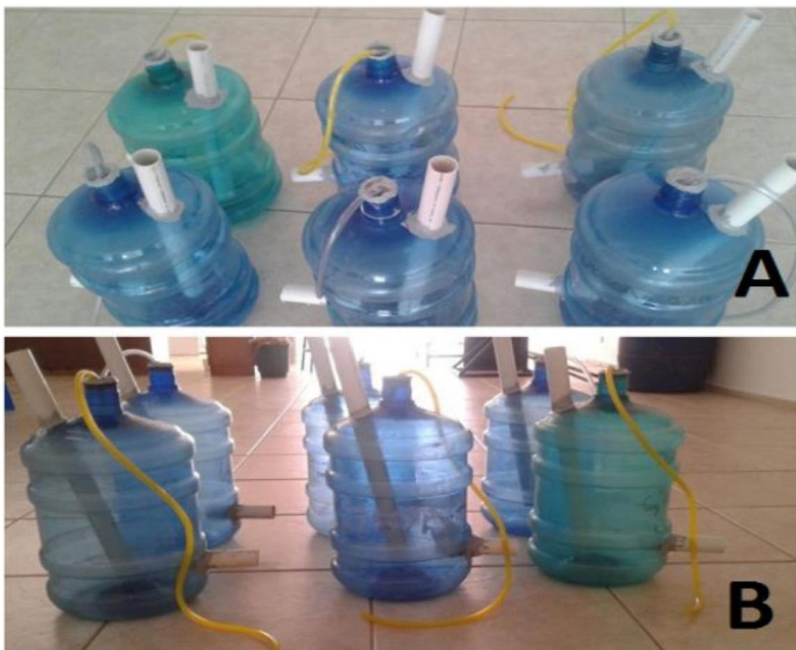
Figura 1 – Biodigestor experimentais montados, antes de serem abastecidos com a maçã refugo picada. A= vista superior, B= vista lateral,
