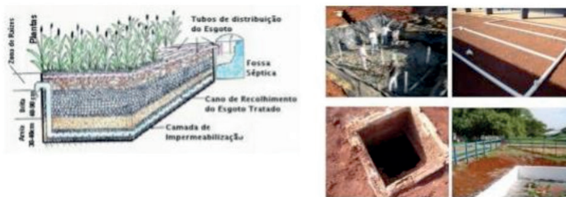
Figura 2. Esquema de uma ETE por zona de raízes e etapas de instalação da ETE por Zona de raízes na Escola Municipal Padre Luigi Salvucci em Foz do Iguaçu, PR.
