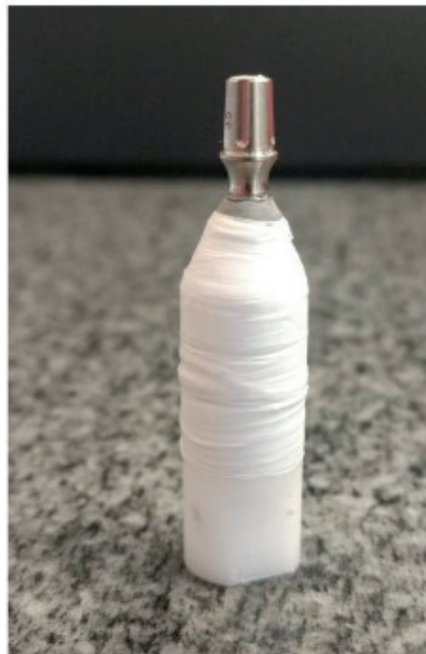
Figura 14. Interface entre implante e pilar vedada com resina flow + resina micro hibrida envoltas por teflon
