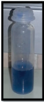
Figuras 2A e 2B - Capacidade tampão - comparação da cor do frasco com o manual do fabricante
