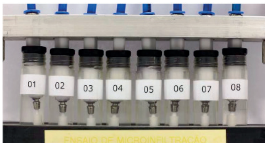
Figura 20. Resultado do teste de microfiltração sem extravasamento do corante
