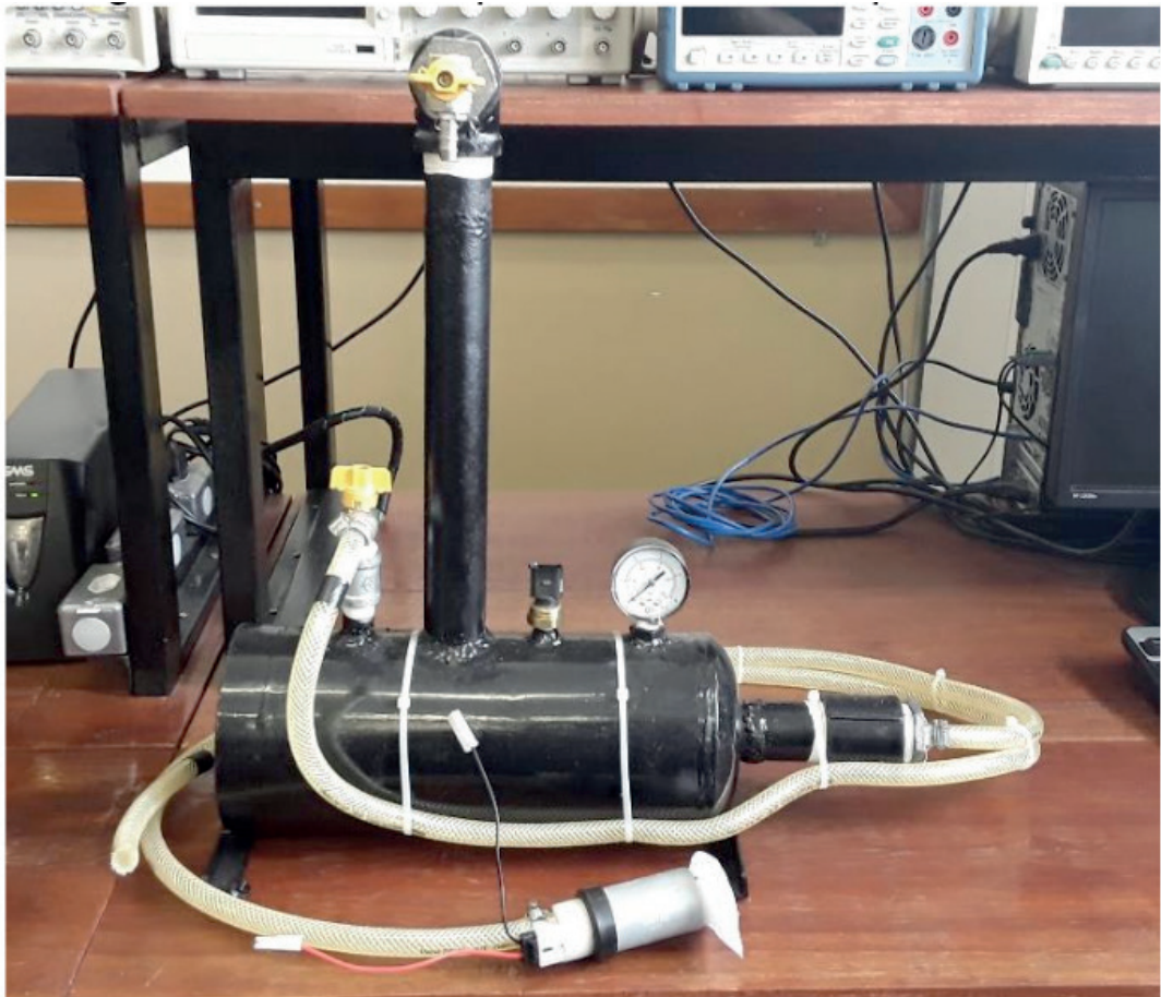
Figura 3 – Vaso de pressão destinado para testes
