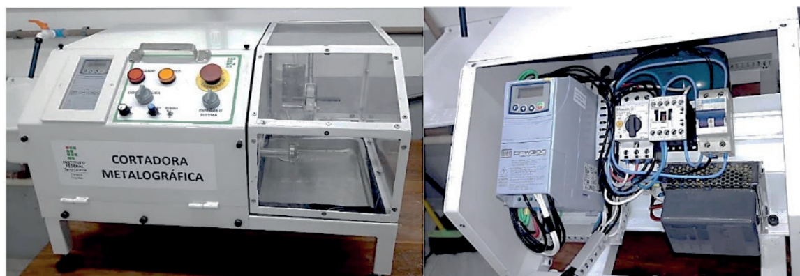
Figura 1 – Cortadora metalográfica construída durante a execução deste projeto por alunos do curso técnico em eletromecânica.
