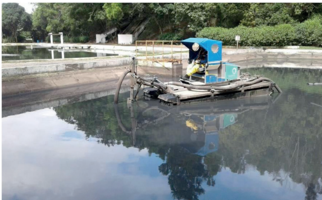
Figura 3. Máquina anfíbia utilizada na remoção de lodo das lagoas de estabilização – ETE Serra Dourada.
