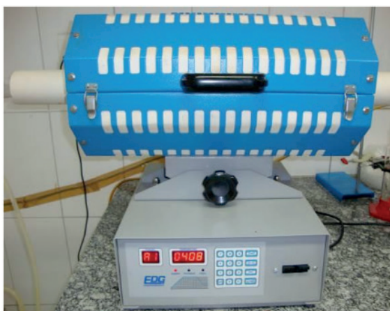
Figura 2: Forno de bancada horizontal de leito fixo
