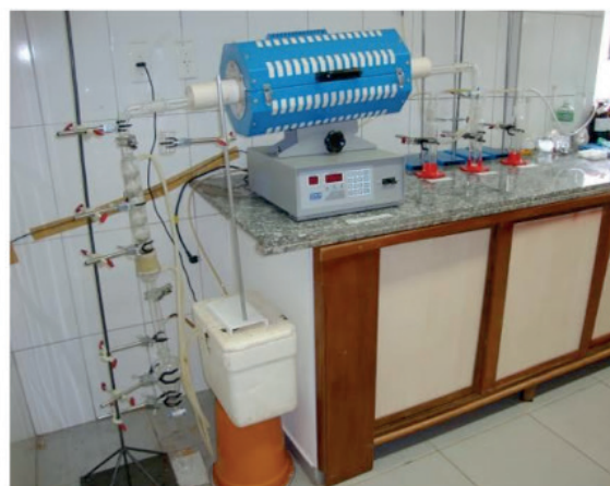
Figura 3: Sistema de pirólise do lodo – entrada de gás, tubo, conjunto de vidraria e lavadores de gases.
