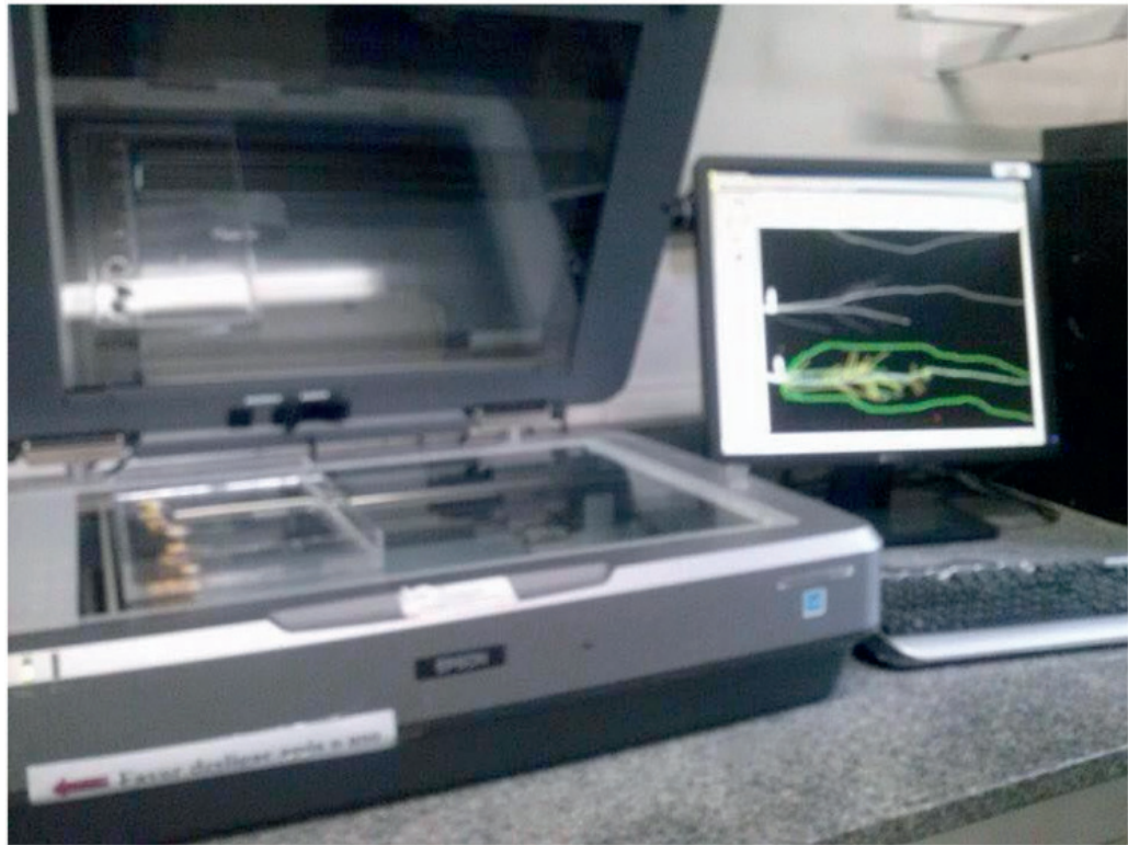
Figura 7 - Raízes dispostas em cuba para digitalização de imagens e análise morfológica de sistema radicular.
