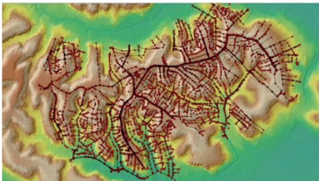
Figura 3 – Representação da Rede no QGIS com a utilização do MDT extraído do PE3D.
