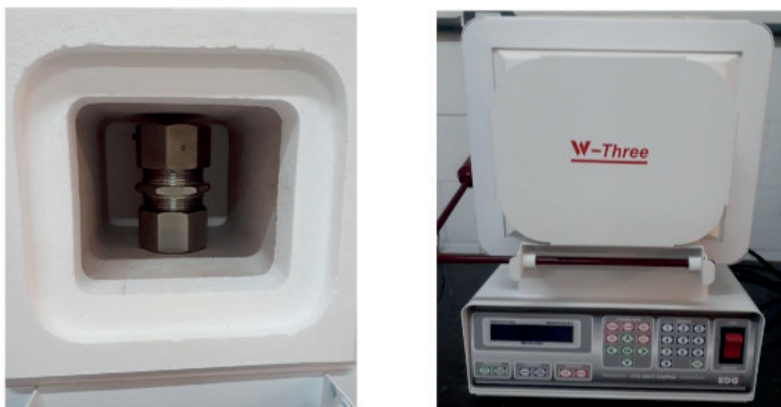
Figura 1: Reator e forno para tratamento hidrotermal convencional. Fonte: Autora
