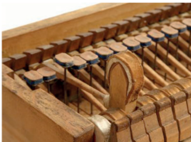
Figura 2: Martelos revestidos por couro em um piano Ignaz Bösendorfer de 1847 © claviersammlung.de.
