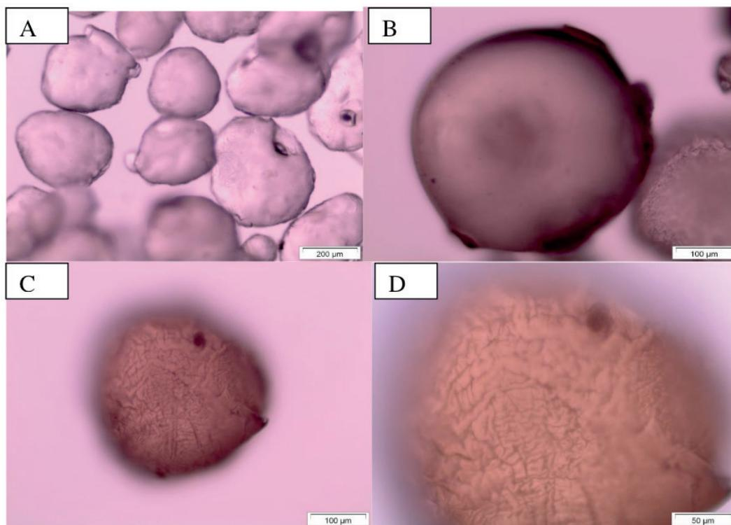
Figura 10- Imagens das microesferas de quitosana obtidas por microscopia óptica. (a) e (b) microesferas de Quitosana e (c) e (d) microesferas tratadas com GA
