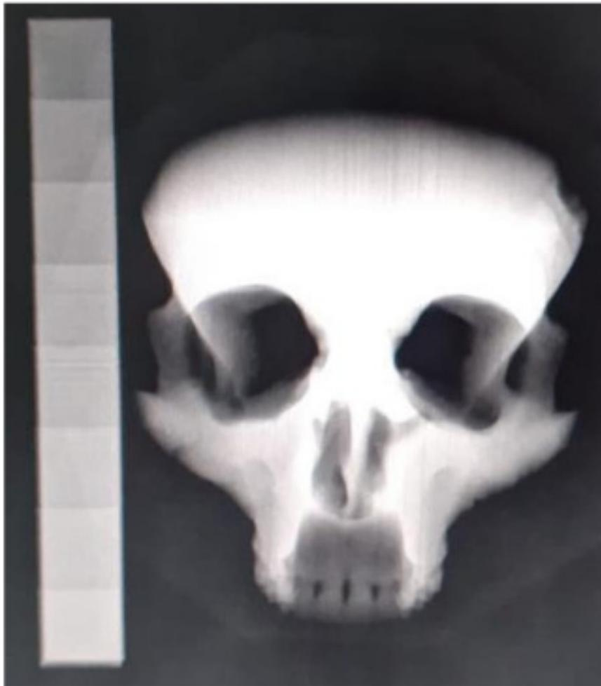
Figura 11: Radiografia do *phantom* e do penetrômetro, técnica 1.
