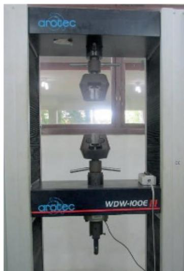
Figura 5. Máquina de Ensaio Universal AROTEC WDW 100E.
