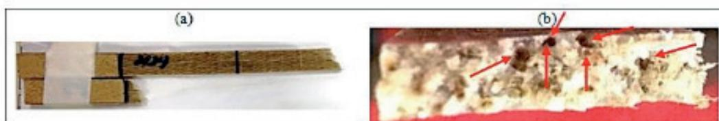
Figura 10. Aspecto da fratura do laminado Juta/Juta/Juta (a) Corpo de prova ensaiado (b) Superfície de fratura.
