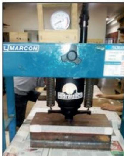
Figura 5. Prensa hidráulica utilizada na compressão.
