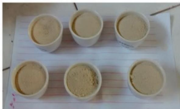
Figura 1. Amostras de fosfato de alumínio e de fosfato de alumínio com adição de escória
