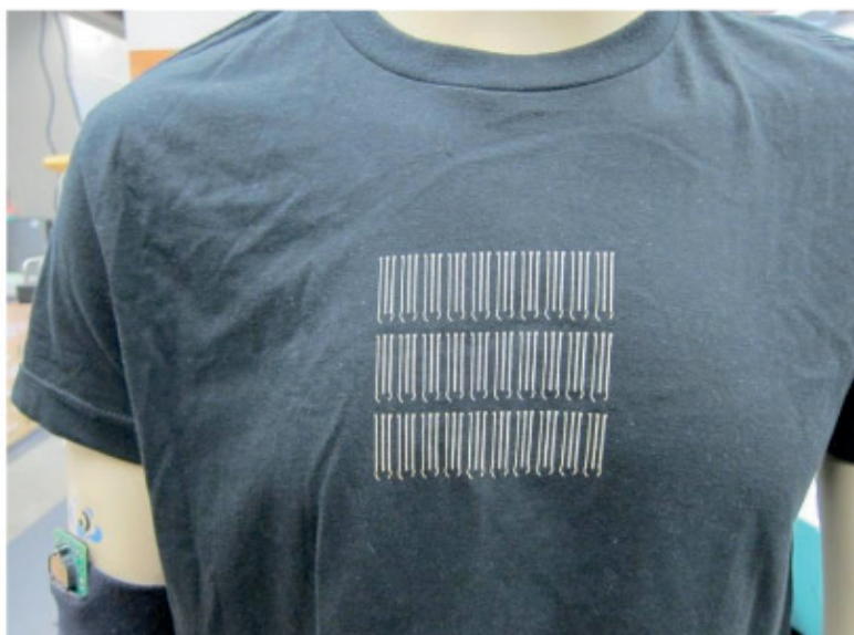
Figura 3 – Eletrodos imprimíveis, nanoengenharia aplicadas no vestuário do projeto ATTACH, Universidade da Califórnia/San Diego.
