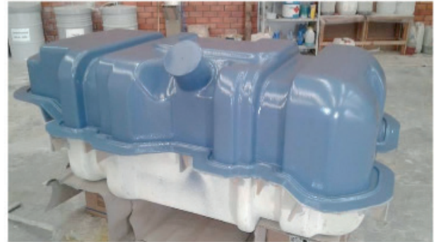
Figura 02: Casca de fibra de vidro laminado Fonte: Do Autor (2016)
