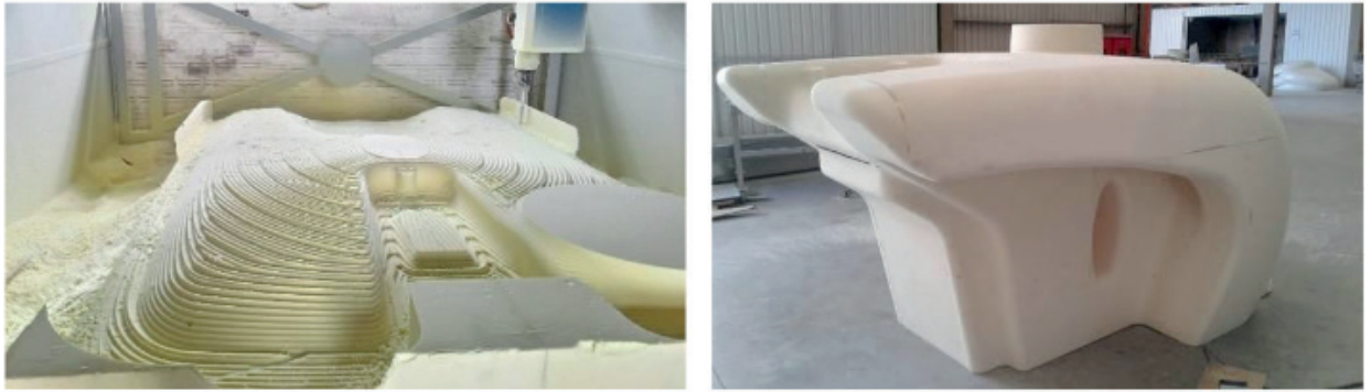
Figura 03: Usinagem e montagem do modelo
