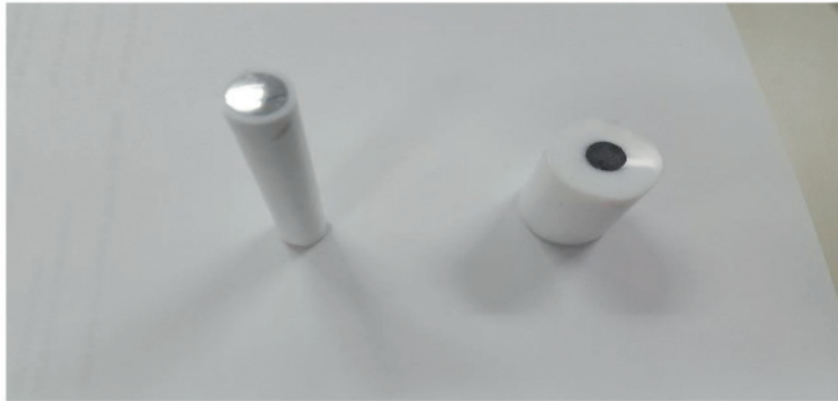
Figura 7: Imagem dos eletrodos após a eletrodeposição da PANI, com pré-tratamento com alizarina.
