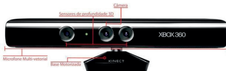
Figura 2. Imagem mostrando detalhes do Microsoft Kinect [Canaltech 2015].
