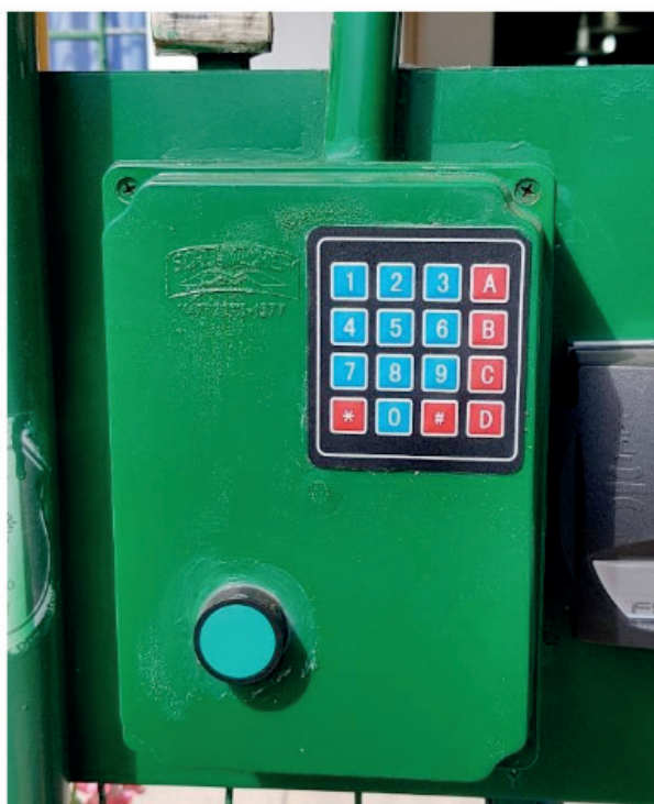
Figura 04: Teclado matricial e botão de acionamento do sinal sonoro
