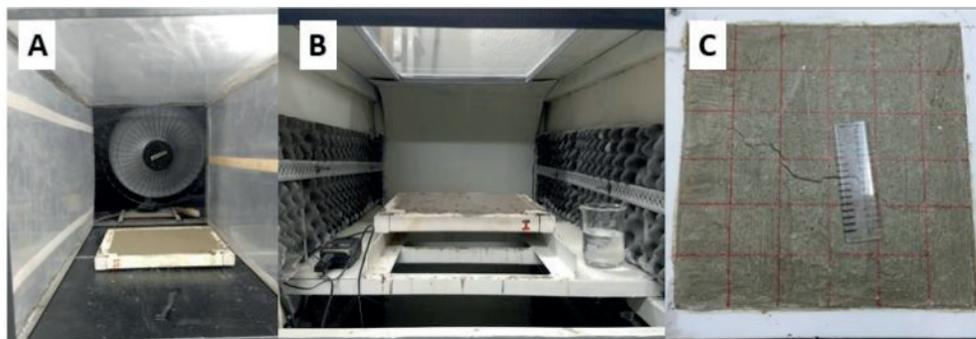
Figura 3 – A) secagem por vento; B) secagem na estufa com variação da temperatura; C) exemplo de placa fissurada.
