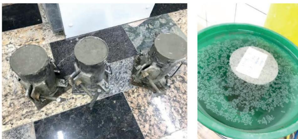
Figura 1 – Moldagem e cura dos corpos de prova
