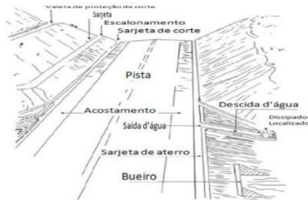
FIGURA 1 - Elementos do sistema de drenagem superficial
