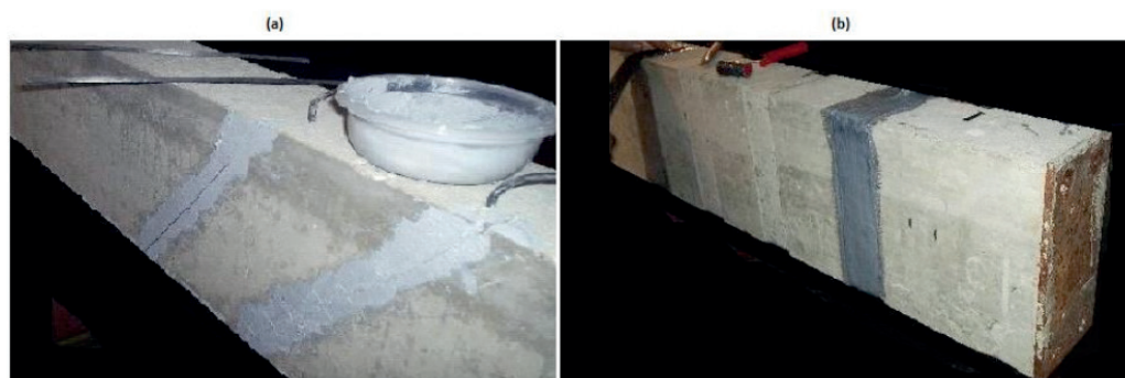
Figura 8: Sistemas de reforço utilizando a) laminados inseridos e b) faixas de tecido
