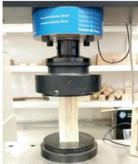
Figura 9: Ensaio de compressão paralela às fibras
