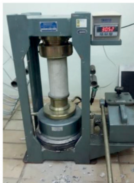
Figura 10: Máquina hidráulica de ensaio em corpos de prova de concreto
