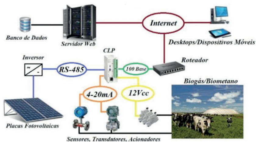
Fig. 5. Diagrama da instrumentação e monitoramento em desenvolvimento para integração das unidades geradoras de energia.
