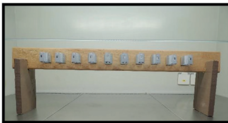
Figura 2 – Vista panorâmica do suporte de madeira com abraçadeiras metálicas. Ribeirão Preto, São Paulo, Brasil, 2019.
