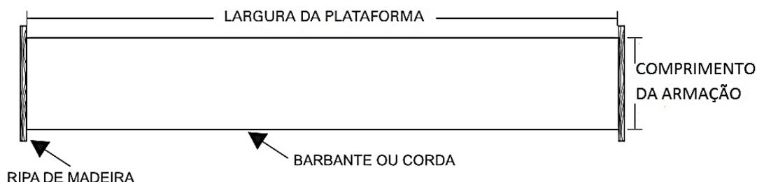
Figura 1. Armação para a determinação das perdas de grãos de soja. Fonte: Mesquita et al. (2011).
