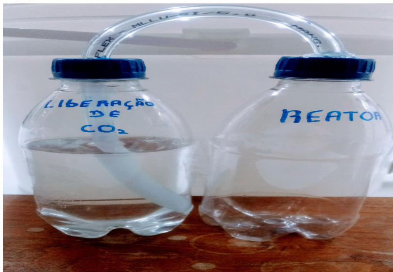
Figura 3 - Reator de garrafa PET com sistema de liberação de CO 2 .
