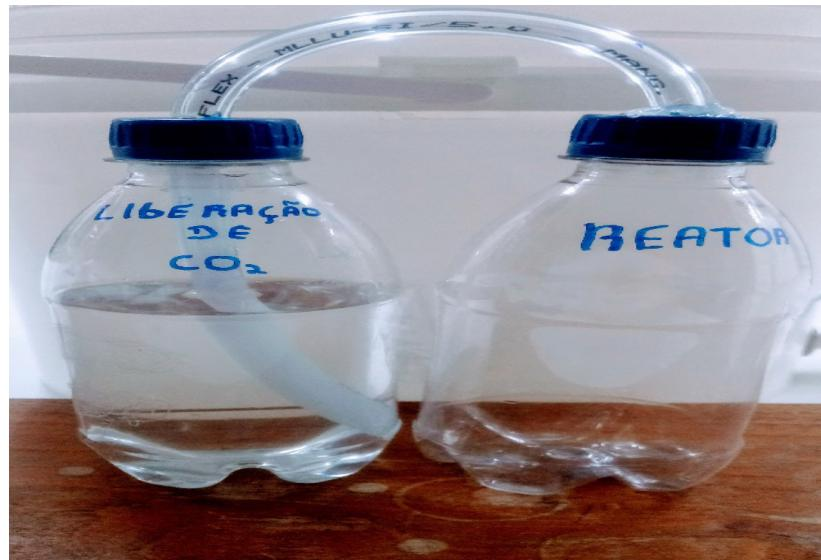
Figura 3 - Reator de garrafa PET com sistema de liberação de CO<sub>2</sub>.
