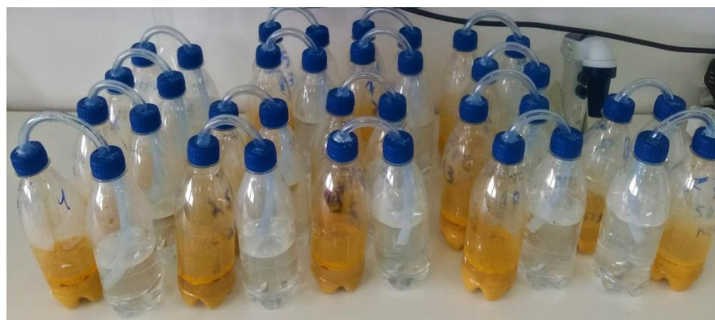
Figura 4 - Reatores utilizados na cinética.
