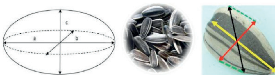
Figura 1. Representação esquemática dos eixos da semente de girassol, considerada esferoide tri axial, com suas dimensões características.
