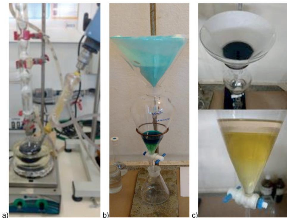
Figura 5: (a) Aparato de transesterificação catalítica de óleo vegetal a 80°C por 4 horas mediante agitação mecânica de 1250 RPM e imagens da filtração da mistura reacional catalisada homogeneamente com (b) acetato de cobre II monohidratado e (c) óxido de cobre II obtido a 550°C.
