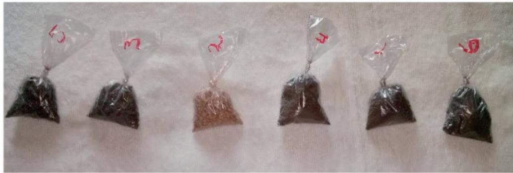
Figura 2 – Amostras prontas para análise no equipamento de fluorescência de raios-X.
