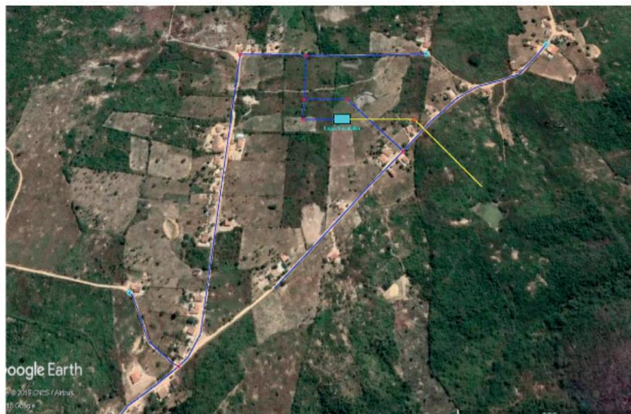
Figura 9 – Traçado da rede coletora
