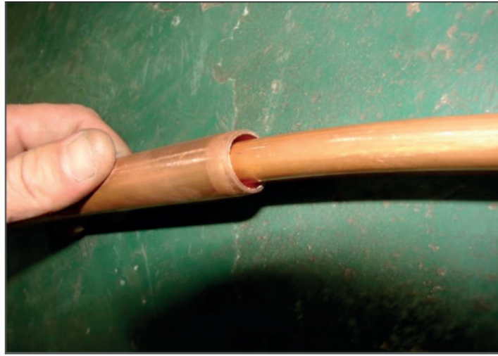
Figura 5: Fabricação do condensador de tubos duplos
