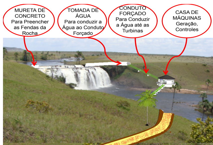
Figura 2: Prospecção do Arranjo da Mini-hidrelétrica da Andorinha
