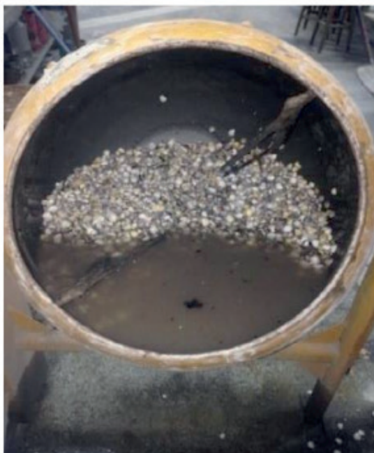
Figura 1. Procedimento de lavagem das conchas em betoneira.
