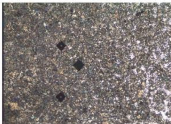
Figura 5. Microestrutura da região de recristalização solda com Argônio (Autores, 2018).
