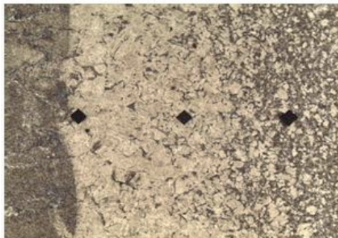
Figura 7. Microestrutura da região de ligação solda com \text{CO}_2 (Autores, 2018).
