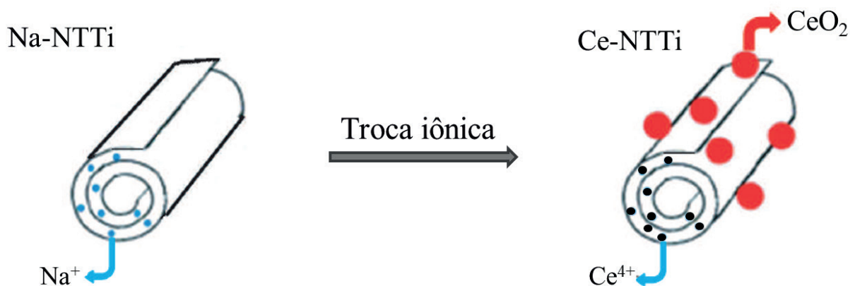
Figura 2 – Esquema de troca iônica na produção de Ce-NTTi, figura adaptada segundo Viana et al (2009).
