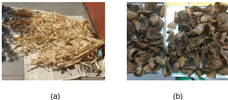
Figura 1 – Matérias primas utilizadas no presente estudo: bagaço de cana-de-açúcar seco (a) e coco verde seco (b)
