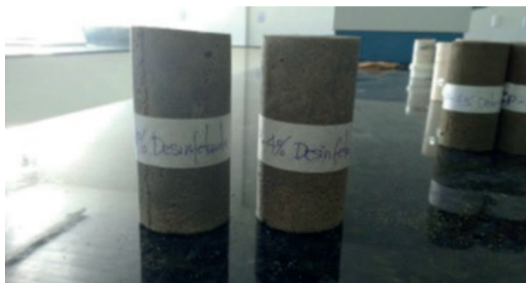
Figura 9 – Corpos de prova com adição de desinfetante.
