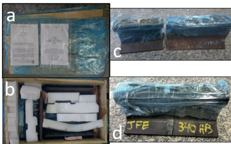
Figura 1 - Trilhos cedidos, em (a) como recebido, (b) aberto, (c) Trilho fraturado e (d) Trilho com defeito superficial.
