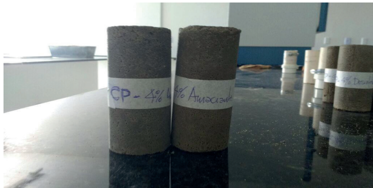
Figura 7 – Corpos de prova com adição de amaciante.
