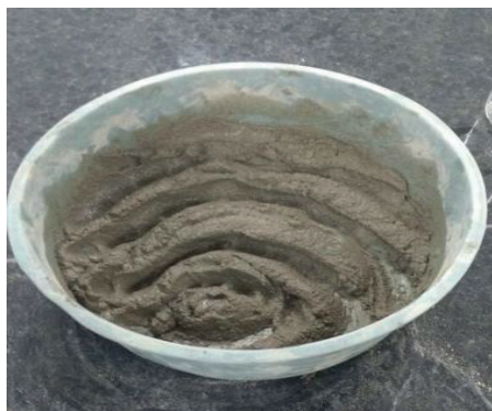
Figura 8 – Argamassa com adição de amaciante.
