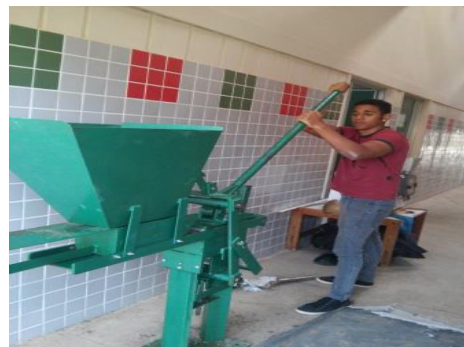
Figura 6. Compactação do tijolo
