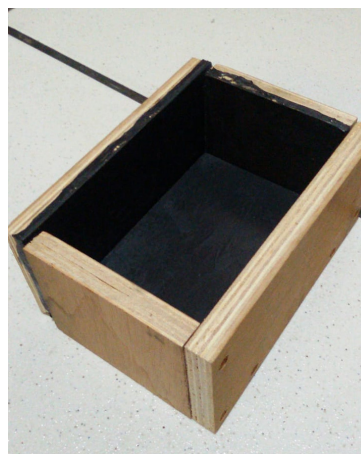
Figura 1. Fôrma de Compensado Revestida em seu Interior (PEDB).
