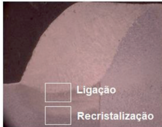
Figura 3. Secção da junta solda com Argônio (Autores, 2018).
