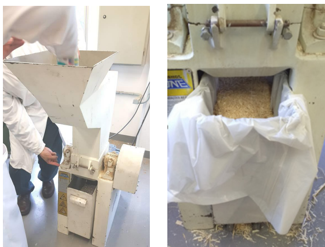
Figura 2 – Triturador utilizado para moagem do bagaço de cana-de-açúcar e do coco verde
