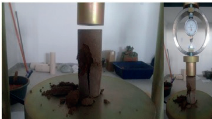
Figura 6 – Corpos de prova após ensaio de resistência à compressão.
